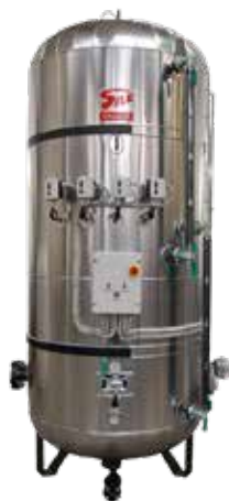
Espansore verticale da l. 3000, pressione d'esercizio 25 bar, temperatura d'esercizio 100 °C, completamente accessorato. Coibentato in lana di roccia da mm 50 e finitura esterna in alluminio sp. 0,8 mm. Certificato INSIEME secondo la Direttiva Europea 2014/68/UE-PED
