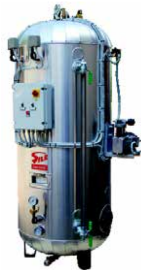
Espansore verticale da l. 5000, pressione d'esercizio 6 bar, per acqua termo t \leq 100^{\circ}\text{C} , zincato e completo di accessori già montati, Coibentazione in lana di roccia da mm 50 e finitura esterna in alluminio sp. 0,8 mm. Certificato INSIEME secondo la Direttiva Europea 2014/68/UE-PED
