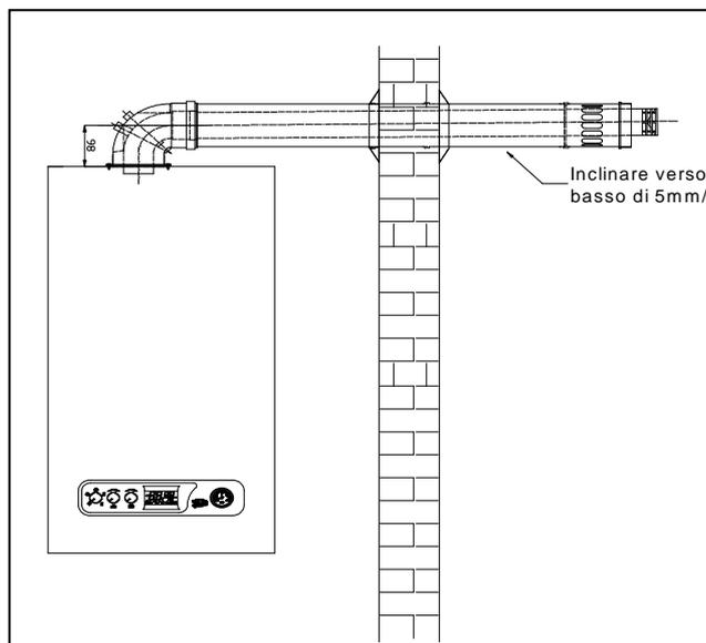
Il doppio condotto coassiale formato da tubo interno di espulsione  $\varnothing$  60 in plastica e tubo esterno di aspirazione aria  $\varnothing$  100 mm in alluminio preverniciato bianco, richiede un solo foro a parete. Il terminale può essere orientato in qualsiasi direzione per lunghezza totale fino a m 5. Per ogni curva aggiunta la lunghezza max consentita deve essere diminuita di m 1.
